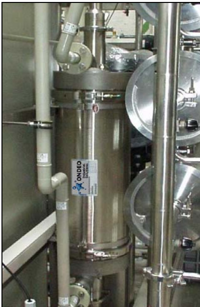
Kontaktor in einer 8m 3 /h ROCEDIS Anlage
